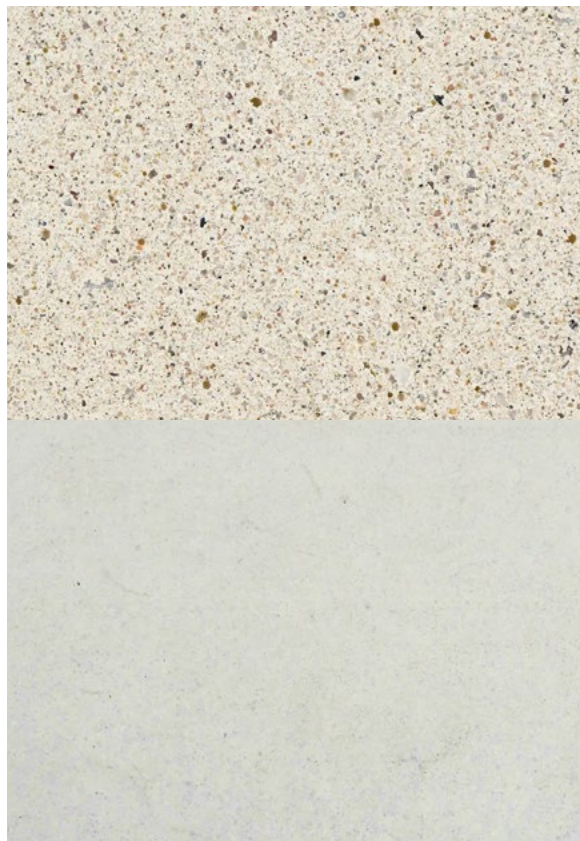
BETONoberfläche Weiss gesäuert und Weiss glatt
